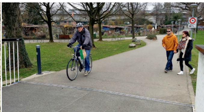
4 | Standard-Zählgerät bei der Wettsteinbrücke (Bild links) und kombinierte Zählstelle für die Erfassung von Fussgängern (Gerät in Pfosten) und Velofahrern (Induktionsschleife) am Birskopfsteig (Bild rechts).
