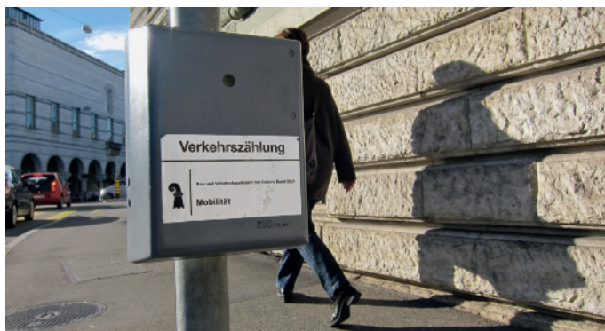
4 | Standard-Zählgerät bei der Wettsteinbrücke (Bild links) und kombinierte Zählstelle für die Erfassung von Fussgängern (Gerät in Pfosten) und Velofahrern (Induktionsschleife) am Birskopfsteig (Bild rechts).
